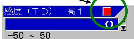
感度 (TD) の合わせ方として、海底を示す木製白いラインが全画面で同じくらいの太さになるように設定値を合わせます。
