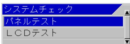
4. 「▲」、「▼」を押し、パネルテスト、またはシステム状態の確認を行うときは、[パネルテスト]を選択します。LCD のチェックを行うときは、[LCD テスト]を選択します。
